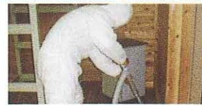
室内塵埃分析 室内塵埃を捕集し、簡易分析とダニ検査法に準じて、その中の微細昆虫等を分離する。
