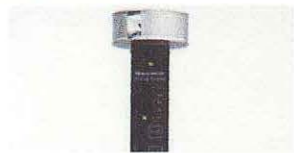
環境浮遊菌：エアサンプラー エアサンプラーを用いて、空気中に浮遊するカビ類を定量的に調査する。
