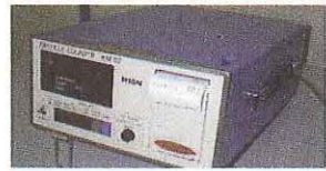
浮遊塵埃 パーティクルカウンターを用いて、塵埃数を測定する。測定は同一場所を3回測定し、その平均値をとる。
