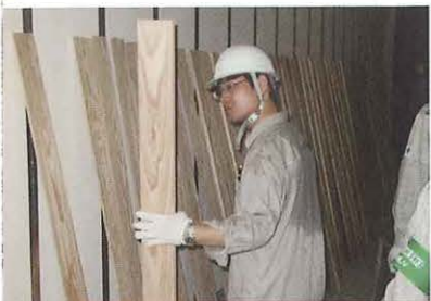
目視での点検
