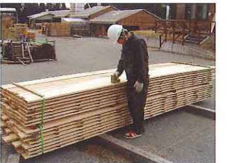
製材時の含水率検査風景【写真2】
