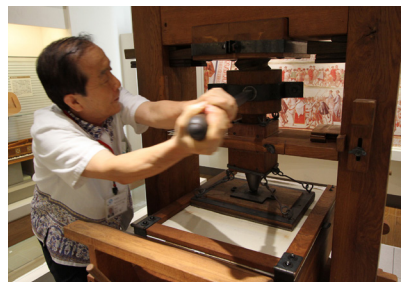
ぶどう酒絞りの要領でネジ式のレバーを手前に引くと圧盤が下がり圧力がかかる
