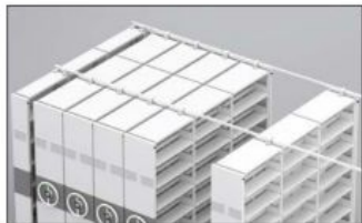
《上部転倒防止金具の設置条件》
