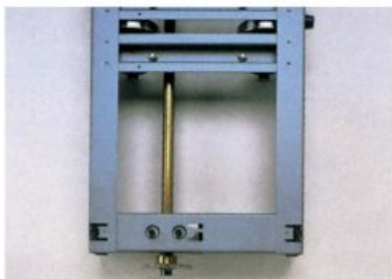
両フランジ車輪と下部転倒防止金具
